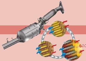
Die Rußpartikel verfangen sich in der keramischen Wabenstruktur des Dieselpartikelfilters. Durch automatische Einleitung von heißen Abgasen oxidiert der gesammelte Ruß und hinterlässt einen gereinigten Dieselpartikelfilter.
