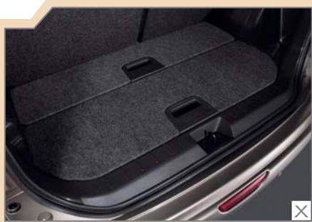
**HIER BEFINDEN SICH BEIDE TEILE DES FLEXI-BOARDS** in der oberen Position, wodurch ein separates unteres Fach entsteht. Das Flexi-Board kann bis zu 100 kg tragen. Alles darunter ist also gut geschützt.
