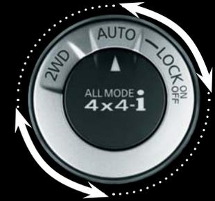
Wenn Sie den Schalter von 2WD auf AUTO stellen, analysiert der NISSAN X-TRAIL das Terrain. Er verteilt genau den richtigen Anteil des Drehmoments auf jedes Rad und ermöglicht auf diese Weise ein optimales Handling auf jedem Untergrund. Wenn Sie zusätzlichen Grip benötigen, schalten Sie auf LOCK und erleben die außergewöhnliche 4x4-Agilität, die NISSAN in Rallyes und bei Langstreckenevents weltweit berühmt gemacht hat.
