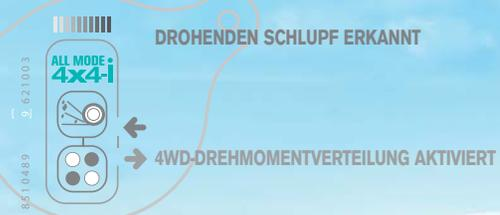
Der NISSAN X-TRAIL ist ein echter 4x4, und er ist mehr als das: Jedes seiner vier Räder hat seine eigene unabhängige Kraftzufuhr – dank des ALL MODE 4x4-i. Die Kraftverteilung reicht von 100%igem Frontantrieb bis zur 50:50-Verteilung Front-/Heckantrieb, abhängig davon, wie der NISSAN X-TRAIL das Terrain und den Grip an jedem Rad berechnet. Sofortige Power und Kontrolle in jeder Situation plus außergewöhnliche Agilität bilden die DNA des NISSAN X-TRAIL.
