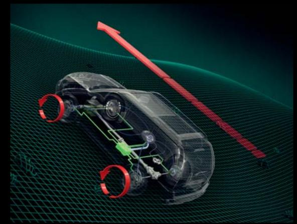
Der Berganfahrassistent wird wirksam, sobald sich der NISSAN X-TRAIL auf einem Anstieg von mehr als 10% befindet. Wenn Sie angehalten haben, können Sie die Bremsen lösen: Das Fahrzeug bleibt, wo es ist. Um zu starten, treten Sie einfach aufs Gaspedal. Das System funktioniert auch im Rückwärtsgang, um beispielsweise auf einem steilen Gefälle rückwärts einzuparken. Der Berganfahrassistent ist sowohl mit Schalt- als auch mit CVT- und Automatikgetriebe erhältlich.
