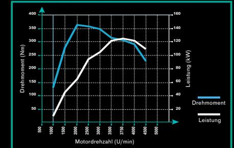
Der 2.0 l dCi mit 127 kW (173 PS) ist der stärkste Motor des NISSAN X-TRAIL. Piezoelektrische Einspritzdüsen und ein Turbolader mit verstellbarer Düse ermöglichen ein außergewöhnliches Drehmoment und eine verblüffende Beschleunigung. Die flexible Bereitstellung des Drehmoments (90 % schon ab 1750 U/min verfügbar) und besonders kultivierte Fahreigenschaften sorgen für ein noch besseres Ansprechverhalten.
